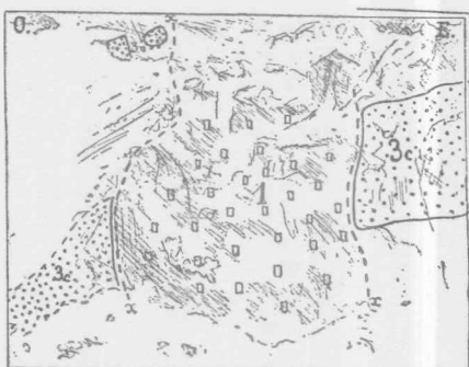
Fig. 24. — Detalle de las figuras 22 y 23 (pl. X). Pedazo del filón estanífero hundido entre dos fallas. Descubridora
